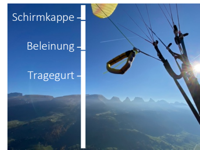
Abb. 6: Aufbau eines Gleitschirms (Nicolas Huber)
