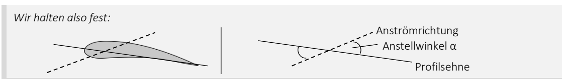
Abb. 18: Anstellwinkel (CleanPNG, angepasst von NH)
